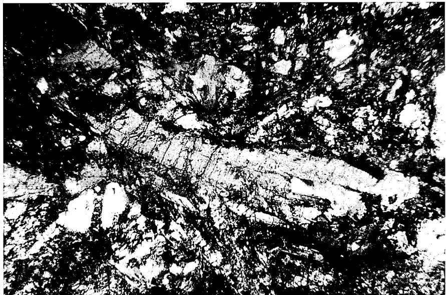
Foto 2.- Fenocristal de augita titanífera de hábito muy alargado en una roca volcánica básica
