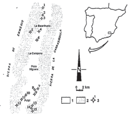
Fig. 1.- Esquema hidrogeológico del acuífero de la Cubeta de Pulpí. 1: arenas y conglomerados con intercalaciones de limos y arcillas del Pliocuaternario (acuífero); 2: rocas de borde; 3: sondeo y su número.
