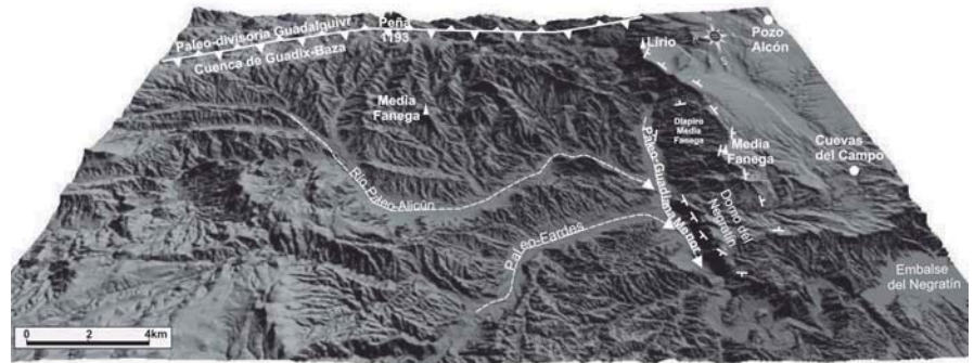
Fig. 2.- Esquema sobre el modelo digital del terreno en el que se muestra la paleo-red de drenaje en el sector de la captura de la cuenca.
