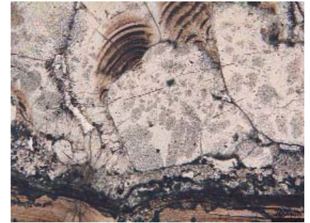
Fig. 8.- Esferulitos fibrosos y calcita sobreimpuesta, con relictos de aragonito fibroso
