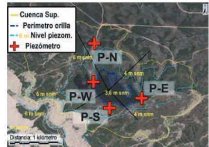
Fig. 2.- Perímetro de la laguna de Santa Olalla, cuenca hidrológica superficial y piezómetros empleados en el estudio. Se señala la división por segmentos de la laguna para la aplicación del método y el nivel piezométrico.
