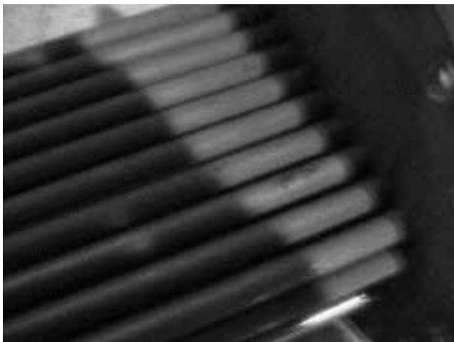
Figura 4. Corrosion en serpentín de acero inoxidable 304
