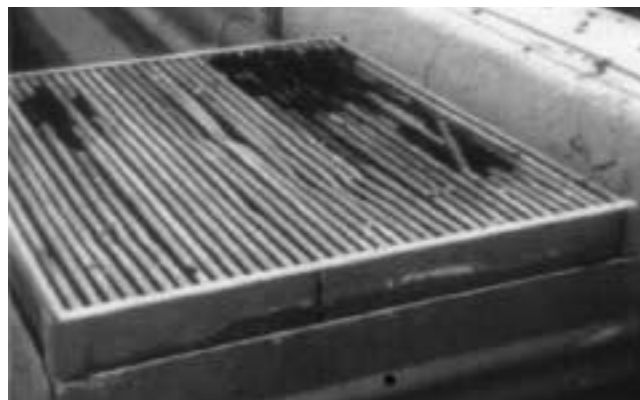
Figura 6: Separador de gotas semidestruido por la corrosión
