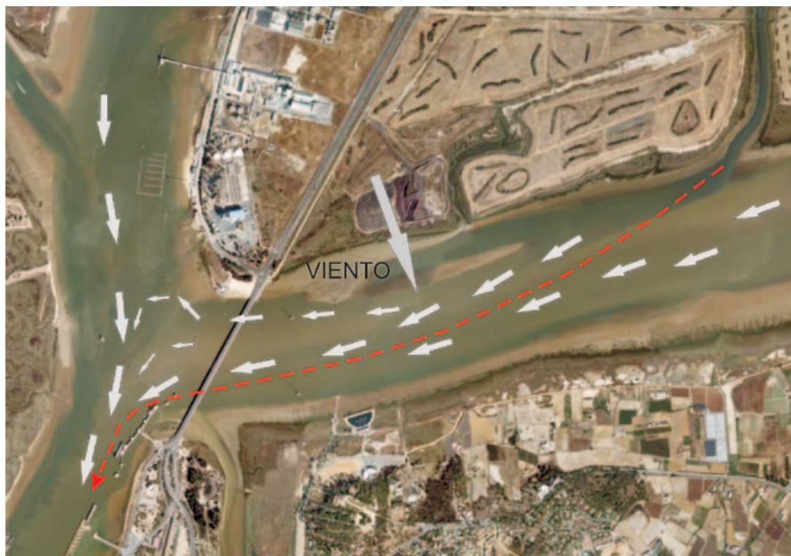
Fig. 4. Esquema hidrodinámico de las corrientes de reflujos de mareas vivas en la confluencia entre el Tinto y el Odiel. La magnitud de las flechas representa la velocidad de las corrientes.
